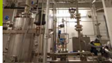
Hochdruckabsorptionsanlage im Miniplantmaßstab. UniCat / C. Eyrich
