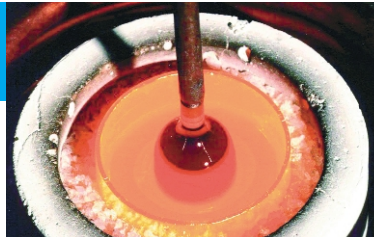
Kristallzüchtung nach dem Czochralski-Verfahren: Der wachsende Kristall wird aus dem Tiegel gezogen IKZ Berlin
