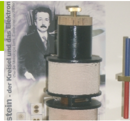
Historischer Aufbau des Einstein-de Haas-Experiments in der PTB
